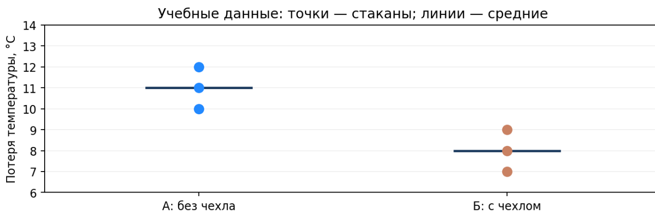
Рисунок 1. Учебная серия: потери за 10 минут, 100 мл, начало 50 °С; А без чехла, Б с двухслойным бумажным чехлом. Точки — отдельные стаканы, n = 3 на группу; линии — средние 11 и 8 °С, не интервалы неопределённости. Авторская диаграмма.
